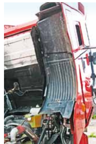
Арки кабины надежно защищены пластиковыми подкрылками
