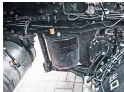
Задняя пневмоподвеска четырехбаллонная, схожая с «МАНовской»
