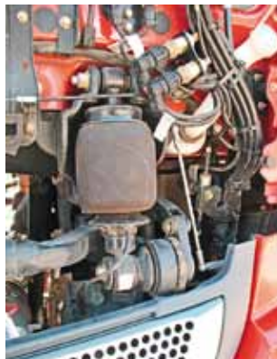
Подвеска кабины четырехточечная, на пневмоподушках большого диаметра
