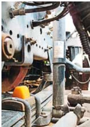
Амортизаторы – китайские, но с наклейкой ZF Sachs
