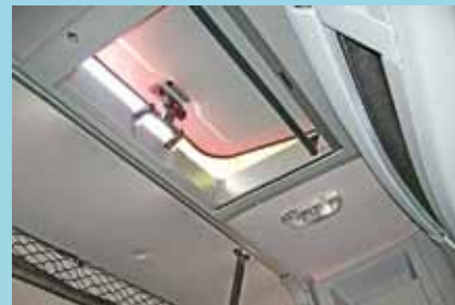
Хотя есть и кондиционер, в крыше все равно смонтирован люк
