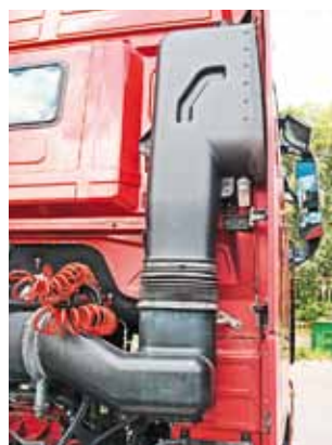
Воздушный фильтр стоит за кабиной, сверху рамы. Повредить его невозможно
