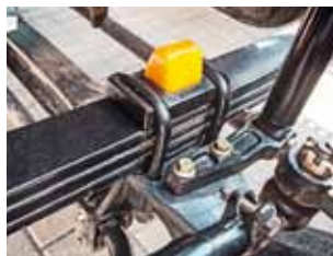
У передней рессоры три листа и долговечный полиуретановый отбойник
