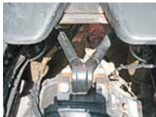
Ведущий мост сверху держит А-образная реактивная штанга
