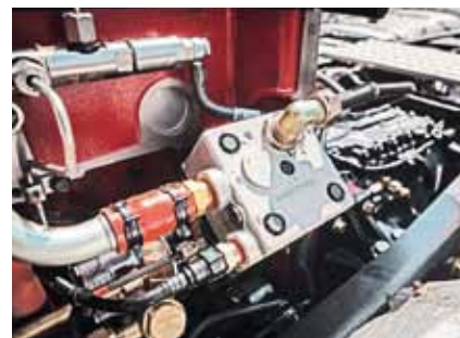
Пневмокомпрессор одноцилиндровый, установлен со стороны маховика
