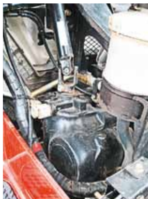
Гидроусилитель руля тоже какой-то лицензионный, скорее всего ZF
