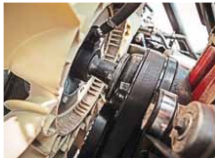
В приводе вентилятора применена электромагнитная муфта
