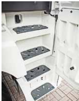
Четыре ступеньки как раз обеспечивают почти ровный пол в кабине
