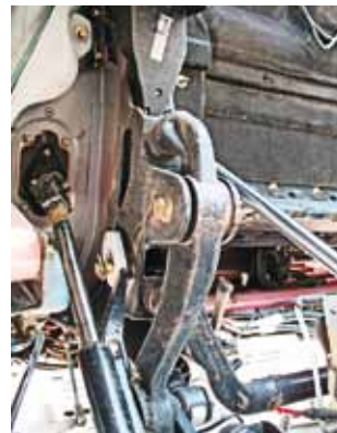
Впереди у кабины есть особые петли для повышения безопасности при ДТП
