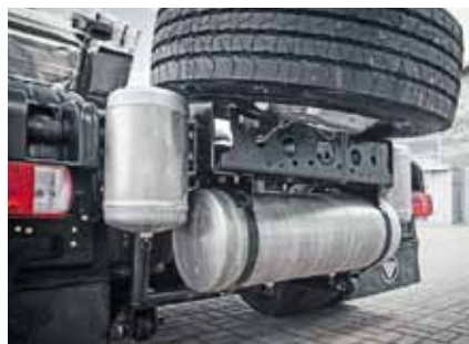
Пневморесиверы алюминиевые, часть установлена в заднем свесе
