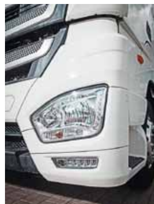
Применена четырехфарная схема освещения. Ходовые огни на светодиодах
