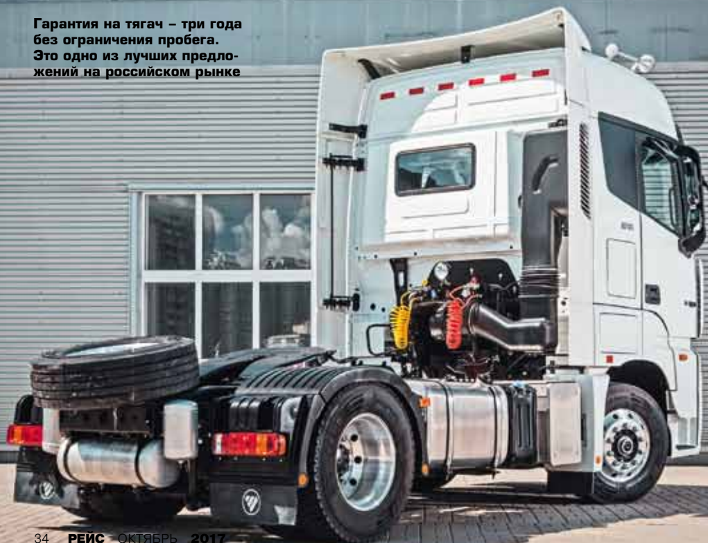
У задних пневмостоек есть дополнительные «горизонтальные» амортизаторы
