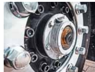
Подшипники передней ступицы смазываются трансмиссионным маслом
