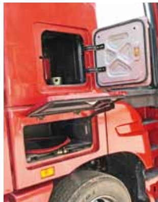
Здесь четыре ящика на боковых панелях. Доступ везде внешний
