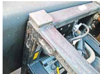
Сварные швы кронштейна резервуара AdBlue усилены накладками
