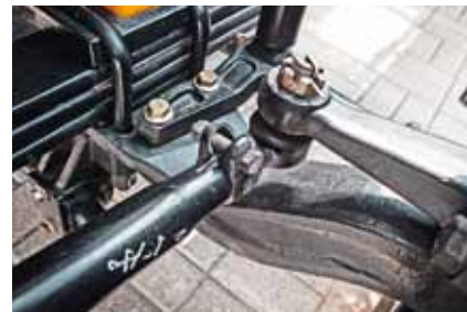
На продольной рулевой тяге есть односторонний шарнир. Выгодно в ремонте!
