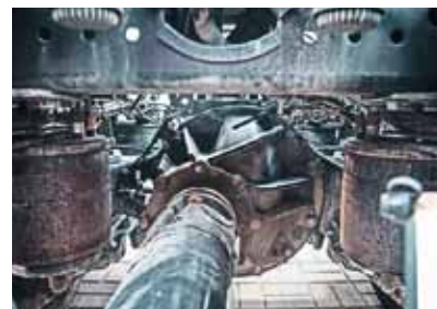
Ведущий мост – с одноступенчатым гипоидным редуктором
