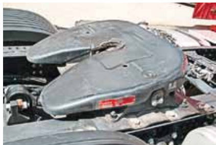
Седло Jost, на шинах с коэффициентом 70 высота ССУ 1150 мм
