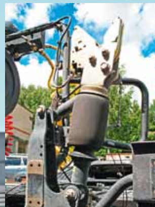
У задних пневмостоек есть дополнительные «горизонтальные» амортизаторы
