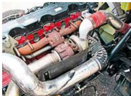
Воздуховоды и выпускная система выполнены из качественной нержавеющей стали
