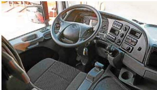
Это панель приборов Mercedes-Benz Actros третьего поколения. Обратите внимание на руль, кран ручника и рычаг КП!
