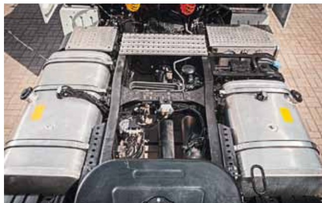
Топливные баки – алюминиевые, хомуты крепления – из нержавеющей стали. Объем баков: 550 и 390 литров
