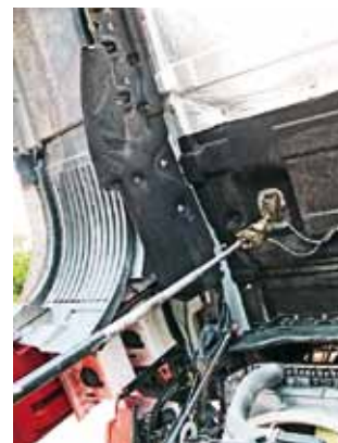
Под кабиной – добротная шумоизоляция. Двигатель капсулирован и по бокам
