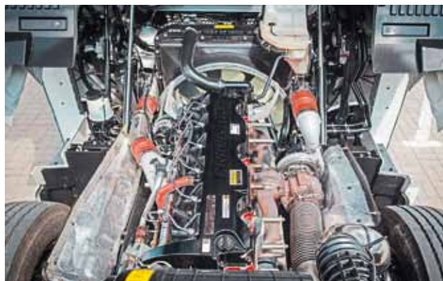
На Foton H5 устанавливают только рядные «шестерки», хотя на Mercedes-Benz Actros стоят V-образные моторы
