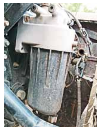
Топливный фильтр-отстойник просто необходим при Common Rail
