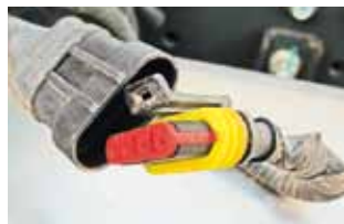
Все разъемы электропроводки герметизированы силиконовыми уплотнителями
