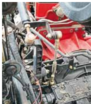
Управление 16-ступенчатой коробкой ZF Ecosplit – телескопической тягой
