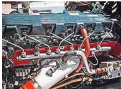
Все современные дизели уровня Евро-5 и Евро-6 оснащены Common Rail
