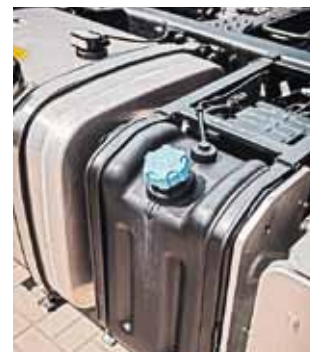
На двигателе Cummins ISG12 применяется технология нейтрализации SCR
